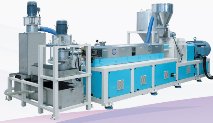
ذات المسمار المزدوج EKA-62D/44 Co-extruder
